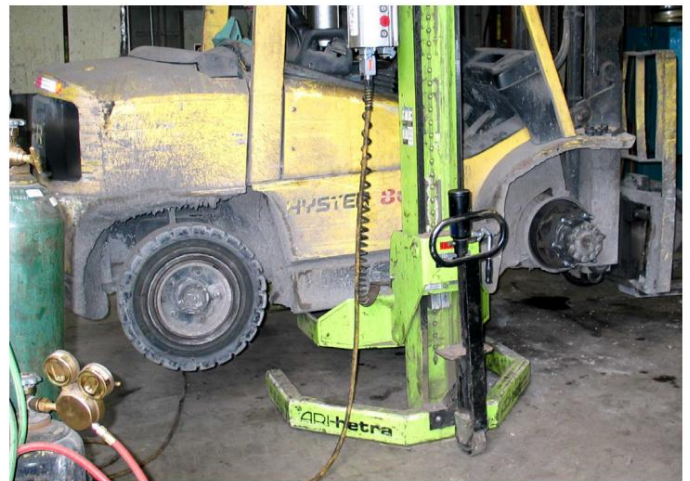
Esta empilhadeira, erguida para trabalhos de reparo, possui energia potencial.
