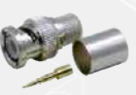
13-10T-1-DGN Conector BNC Macho con anillo de presión p/cable Belden 9913, LMR@400, WBC-400, pin cautivo bañado en oro
