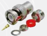
13-01F-3-DGN Conector BNC Macho con anillo para enroscar p/cable RG58A/U, LMR@195 y pin bañado en oro y aislante Delrin (polímero)
