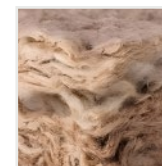
5 RELLENO MATERIAL IGNIFUGO CON ROCA VOLCÁNICA.
