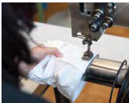
Confección de mangas de conexión
