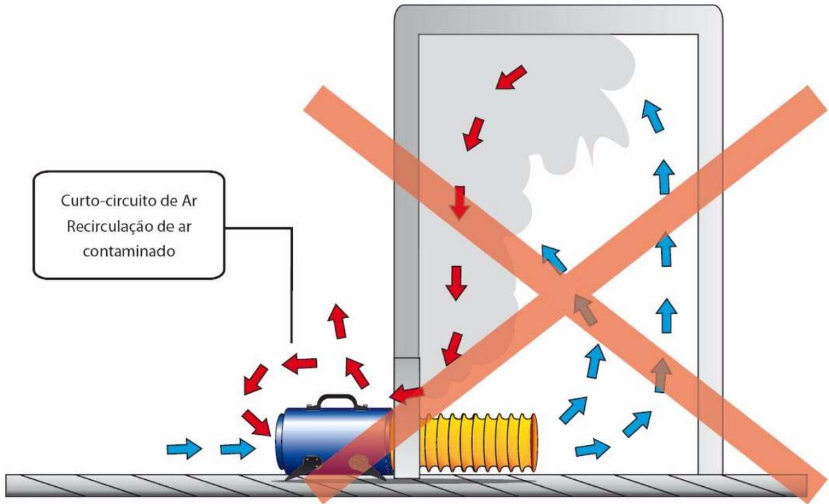
Sistema de Ventilação por Insuflação
