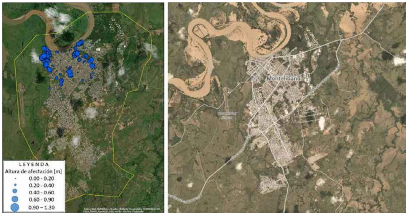
Figura 18. Validación del modelo hidráulico a partir de la información levantada en campo.
