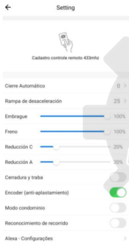
**Cierre automático:** Esta función se utiliza para cerrar automáticamente el portón después del tiempo programado siempre que el imán reconozca el sensor de apertura "FA", de esta manera comenzará el conteo de cierre automático.
