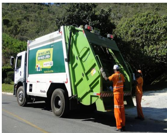
Figura 7-12 – Coleta seletiva manual com caminhão compactador.
