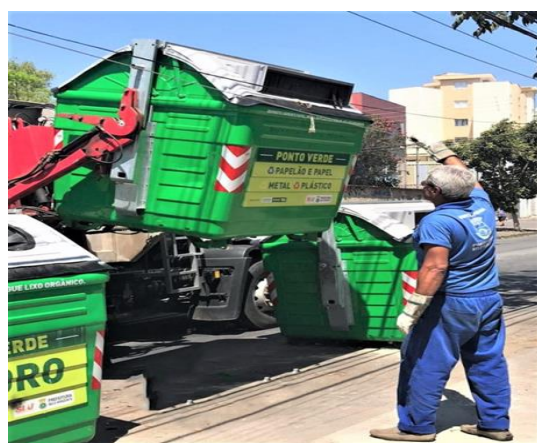
Figura 7-13 – Coleta seletiva automatiza ponto a ponto com carga lateral.
