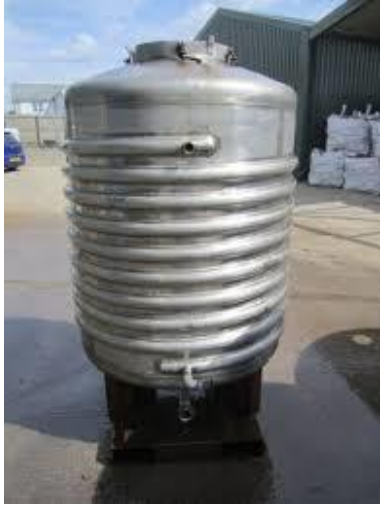
Figura 2 (d) Schimbător cu serpentină exterioară
