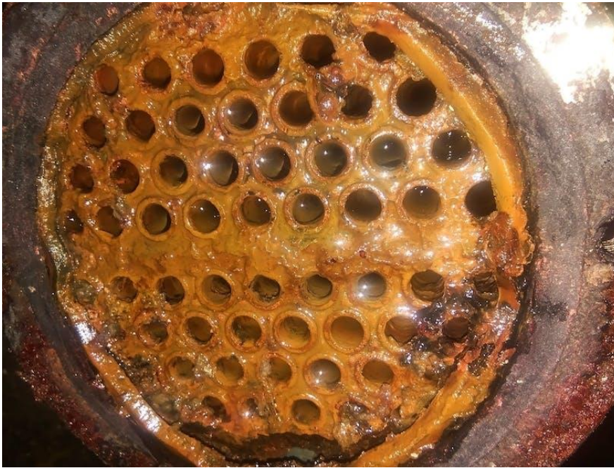
Fig.1 Coroziune accentuată datorată alegerii defectuoase a materialului
