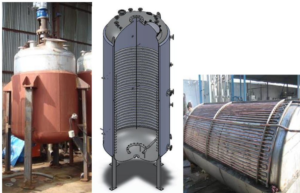
Figura 2 Schimbătoare de tip recipient cu manta (a) sau serpentină (interioară-(b) sau exterioară (c))
