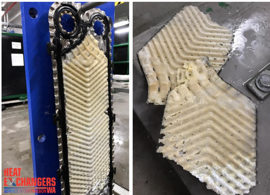
Depuneri \text{CaCO}_3 în diverse schimbătoare de căldură
