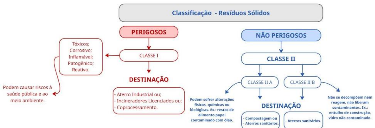
Figura 5: Classificação dos resíduos sólidos de acordo com a NBR 10004:2004.
