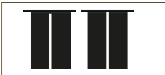
Conjunto 2 patas fabricadas en chapa doblada de hierro y recubrimiento con imprimación y triple capa de pintura.
