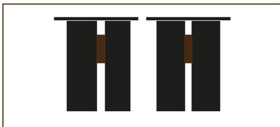
Conjunto 2 patas fabricada en chapa de hierro y travesaño metálico o de madera.
