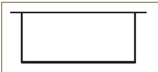
Conjunto 1 pata fabricada en chapa doblada de hierro y recubrimiento con imprimación y triple capa de pintura.
