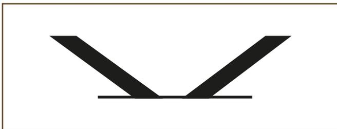
Conjunto de 1 conjunto2 de patas metálicas + base fabricadas con tubulares metálicos de hierro y recubierto con imprimación y triple capa de pintura. Base de chapa metálica de mismas características.
