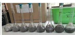
Figura 2. Curva de calibración púrpura de Cassius. De izquierda a derecha concentraciones de 15,0 mg/L, 20,0 mg/L, 25,0 mg/L, 30,0 mg/L, 35,0 mg/L, 40,0 mg/L, 45,0 mg/L, 50,0 mg/L
