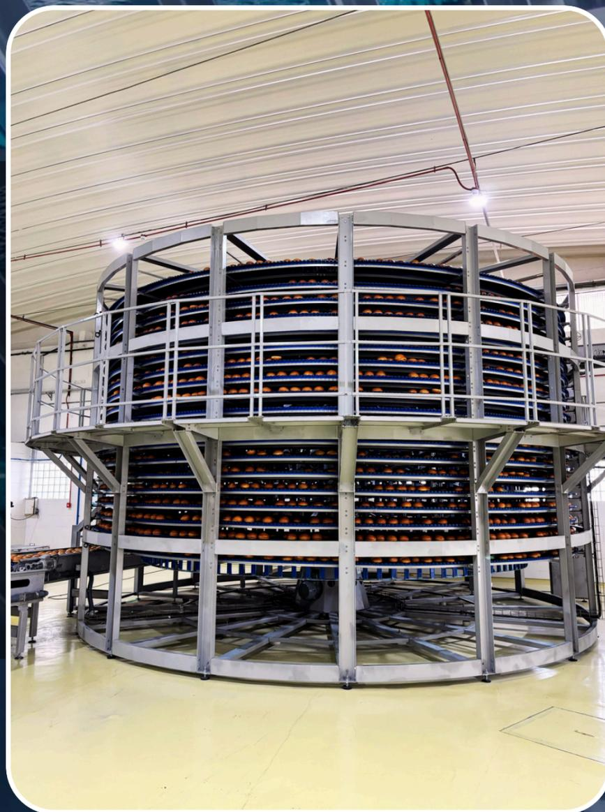
Os sistemas em espiral são soluções compactas e de alta eficiência, projetadas para maximizar o aproveitamento de espaço por meio de esteiras dispostas em níveis circulares. Ideais para processos como congelamento, resfriamento, oferecem desempenho térmico superior, operação contínua e elevada capacidade produtiva.
