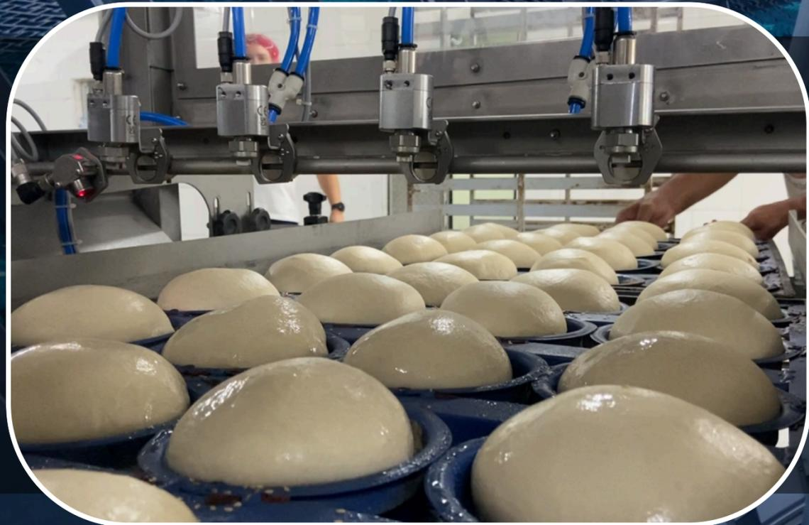
O Seeder realiza a aplicação precisa de grãos e líquidos, assegurando máxima eficiência e mínimo desperdício. Todo o excedente é recolhido e reaproveitado, tornando o processo não apenas produtivo, mas também sustentável e economicamente vantajoso.
