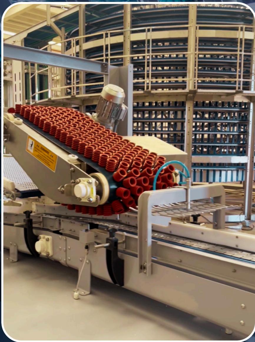
O nosso depanner foi desenvolvido para remover os produtos da forma com precisão, evitando qualquer dano à sua integridade. Utilizando um sistema de ventosas e vácuo, realiza a separação de maneira eficiente e segura. Em aplicações específicas, também é possível extrair tampas metálicas por meio de tecnologia magnética, garantindo agilidade e confiabilidade no processo.
