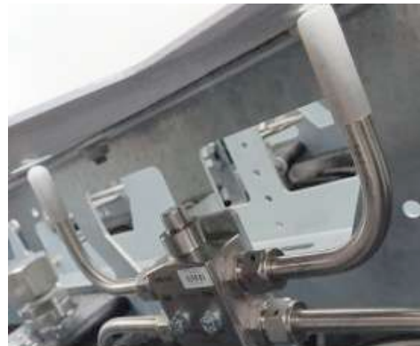
Fusible thermique (TPRD) et échappement en partie haute du camion © Air Liquide
