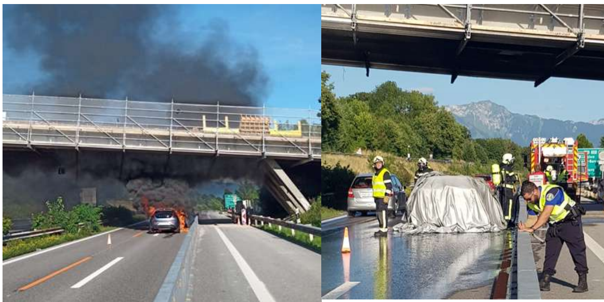
Exemple d'utilisation de la couverture d'extinction lors d'un feu de voiture sur l'autoroute © SIS Riviera (Suisse)
