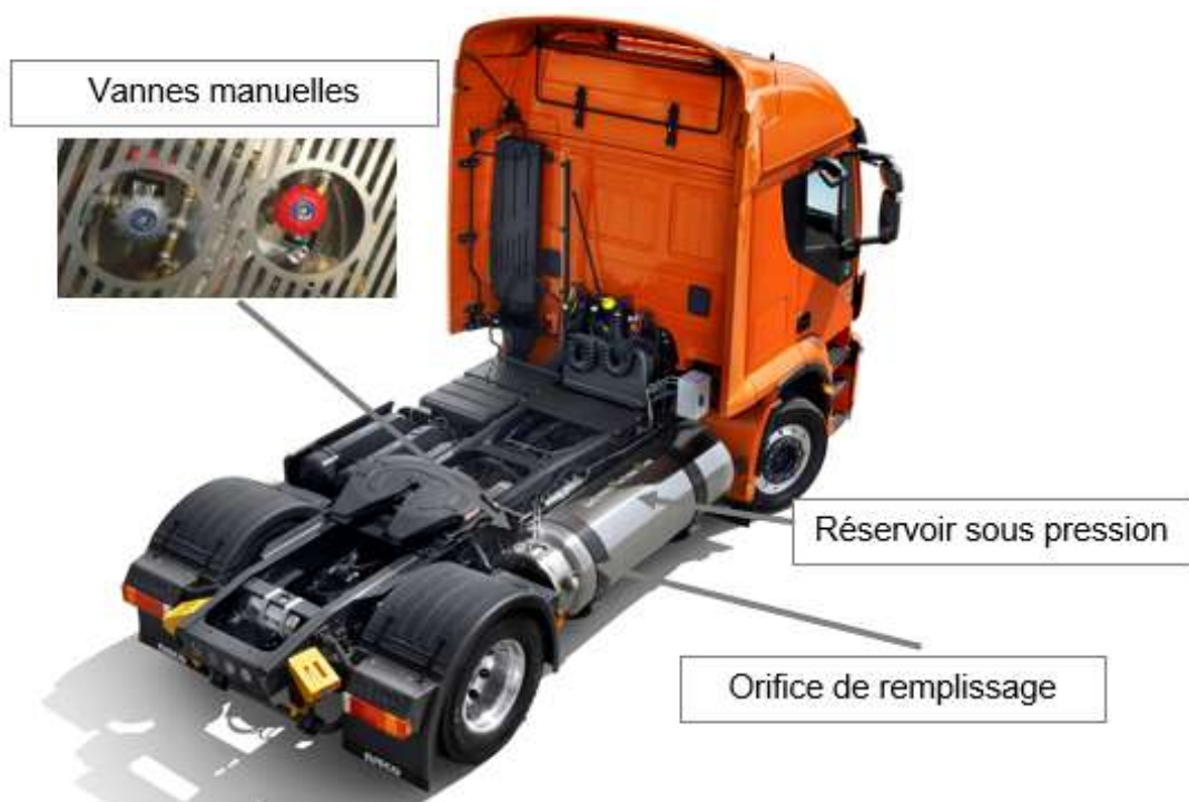
Equipements spécifiques d'un véhicule GNL © BPPM
