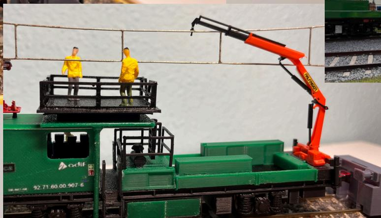
Incluye pantógrafo para medir los descentramientos de catenaria
