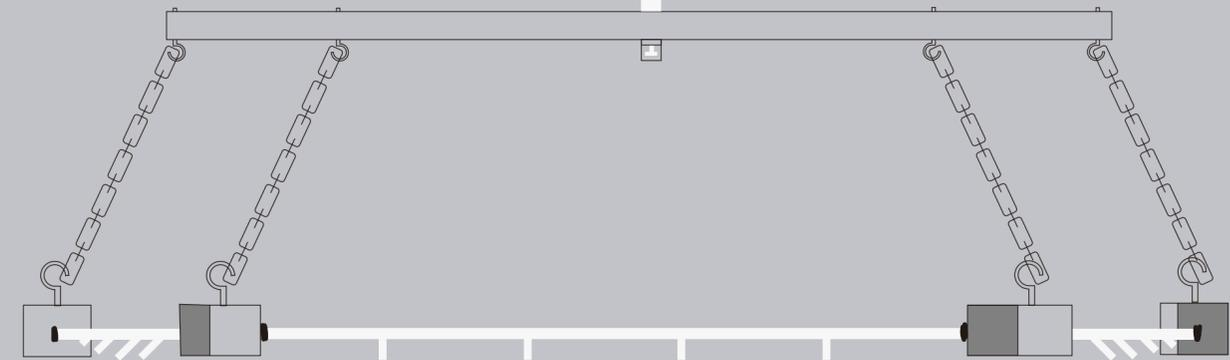
Se construyó una segunda circunferencia de menor tamaño para colgar la pieza de acuerdo a las instalaciones de la universidad. Esto evita perforar varias veces en el techo al transformar los 6 enganches necesarios en uno solo, el cual se engancha al soporte del proyector de la sala de exposición. La unión entre ambas circunferencias se realiza mediante cadenas, que permiten regular la altura.
