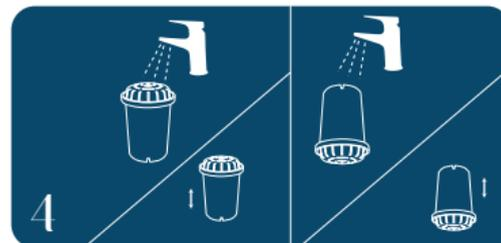
Saca el filtro del agua. Enjuágalo bajo agua corriente durante 20 segundos. Agita el filtro varias veces. Voltéalo boca abajo y enjuágalo bajo agua corriente durante otros 20 segundos. Agítalo hacia arriba y hacia abajo varias veces. Notarás que se eliminarán partículas de carbón activado, esto es normal.
