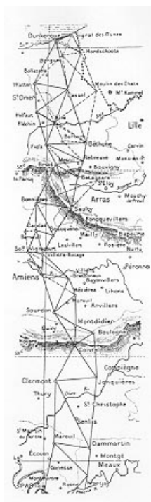
Figure 8. Exemple de triangulation géodésique réalisée entre 1683 et 1718 pour mesurer la méridienne de France
