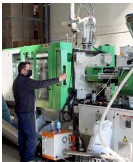
Operario al mando de la máquina de inyección encargada de la producción de los productos de la gama agroplastic tech.
