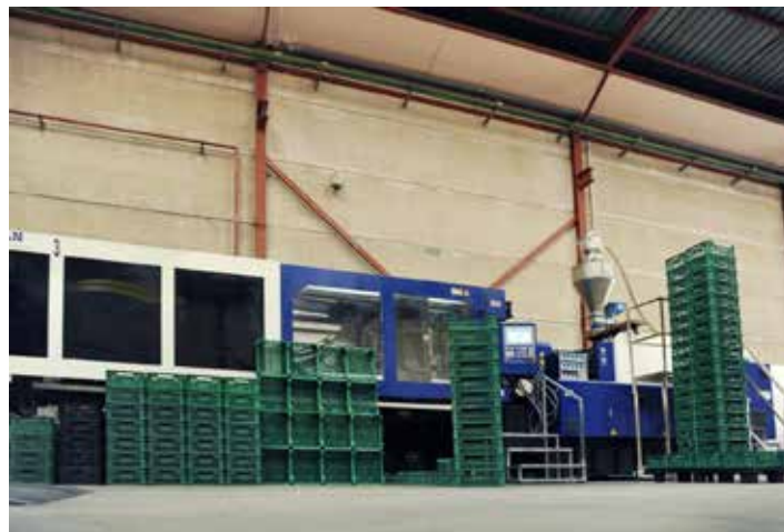
Máquina de inyección que transforma el plástico reciclado en cajas nuevas listas para su uso en el sector agrícola. Foto: Enri Sobrino.
