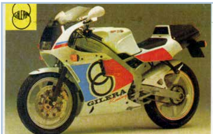
GILERA SP 01. - Cilindrada: 124,3 cc. Precio: 550.000 Pts. Velocidad: 180 Km/h.
