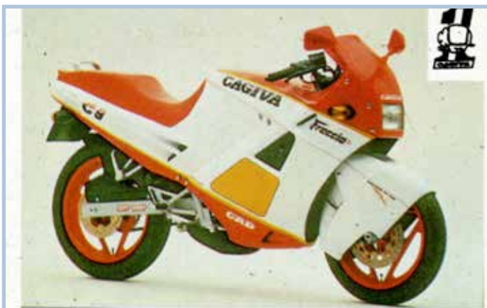
CAGIVA FRECCIA 125. - Cilindrada: 124,6 cc. Precio: 588.422 Pts. Velocidad: 150 Km/h.
