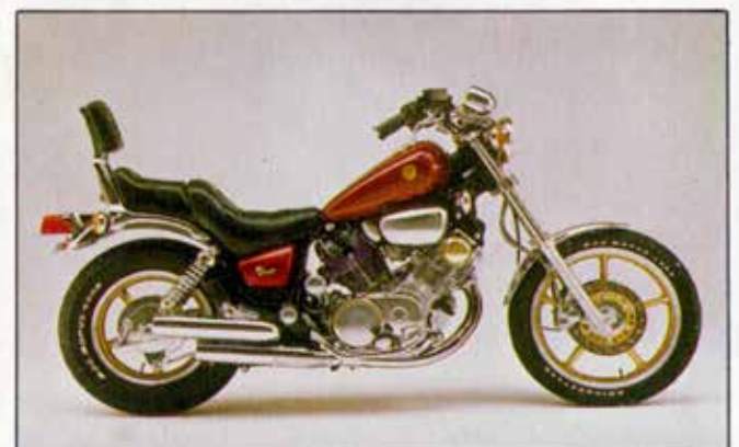
YAMAHA - XV 1000 - (J) C.C.: 981 - CV-rpm: 63,5-6500 - Peso: 220 Kg.
