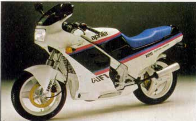
APRILIA - AF-1 125 - (I) C.C.: 123,6 - CV-rpm: 26-9000 - Peso: 120 Kg.
