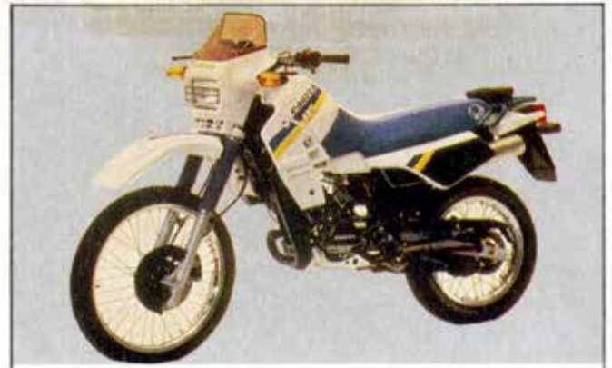
CAGIVA - Elephant-3 125 - (I) Precio: 450.000 Ptas. C.C.: 124,63 - CV-rpm: 19,5-8250 - Peso: 124 Kg.
