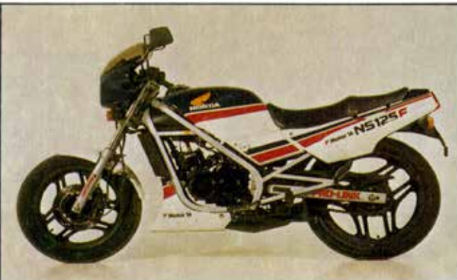
HONDA - NS 125 F - (J) Precio: 449.000 Ptas. C.C.: 124,63 - CV-rpm: 23-9500 - Velocidad: 140 Km./h.
