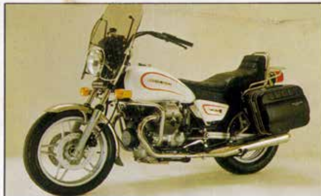
MOTO GUZZI - V 65 Custom - (I) Precio: 855.562 Ptas. C.C.: 643,4 - CV-rpm: 52-7050 - Peso: 170 Kg.
