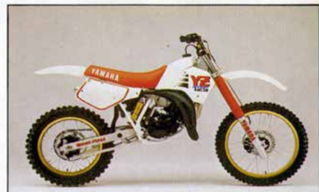
YAMAHA - YZ 125 - (J) Precio: 553.000 Ptas. C.C.: 123 - CV-rpm: 37,1-1100 - Peso: 87 Kg.
