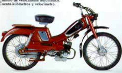
RURAL tipo 00089 (AV-89) Motor 2 tiempos de 49,9 cc. Cambio de velocidades automático. Cuenta-kilómetros y velocímetro.
