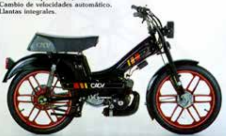
RURAL tipo 00089 (AV-89) Motor 2 tiempos de 49,9 cc. Cambio de velocidades automático. Cuenta-kilómetros y velocímetro.
