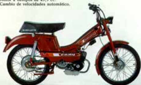
CADY tipo 00290 Motor 2 tiempos de 49,9 cc. Cambio de velocidades automático.
