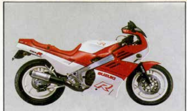
SUZUKI - GSX 400 R - (J) C.C.: 398 - CV-rpm: 59-12000 - Peso: 153 Kg.
