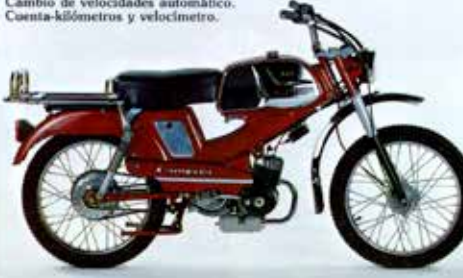
CAMPERA tipo 00353 (SP-95 R) Motor 2 tiempos de 49,9 cc. Cambio de velocidades automático. Cuenta-kilómetros y velocímetro.
