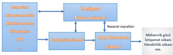
Şək. 3. İntellektual naviqasiya və idarəetmə sisteminin strukturu
