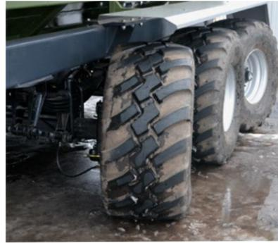
UN PREMIER ET UN DERNIER ESSIEU À DIRECTION HYDRAULIQUE (PBN-40 ET PBN-50).
