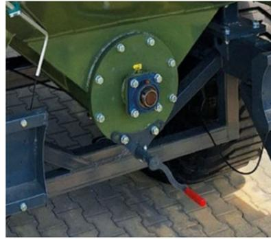
MÉCANISME À VIS D'OUVERTURE DU VOILET DE NETTOYAGE DE LA VIS SANS FIN HORIZONTALE
