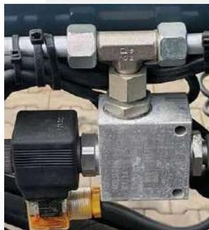
ХИДРАУЛИЧНИ ВЕНТИЛ ЗА БЛАННЕ HYDRAULIQUE POUR BLOQUER L'OUVERTURE DU PORTAIL COULISSANT À PRISE DE FORCE FIXE
