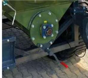
MÉCANISME À VIS D'OUVERTURE DU VOILET DE NETTOYAGE DE LA VIS SANS FIN HORIZONTALE
