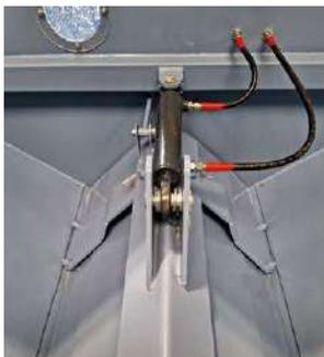
UNE VANNE COULISSANTE QUI S'OUVRE HYDRAULIQUEMENT. ELLE ALIMENTE UNE VIS SANS FIN EN CÉRÉALES.
