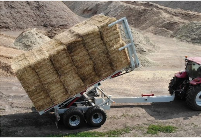
Le déchargement de la semi-remorque à balles sur une surface plane et solide prend 30 à 40 secondes
