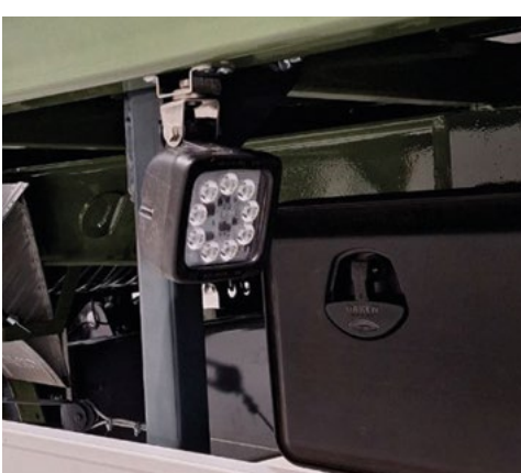
Feux LED latéraux et arrière pour éclairer la piste technologique sur le terrain
