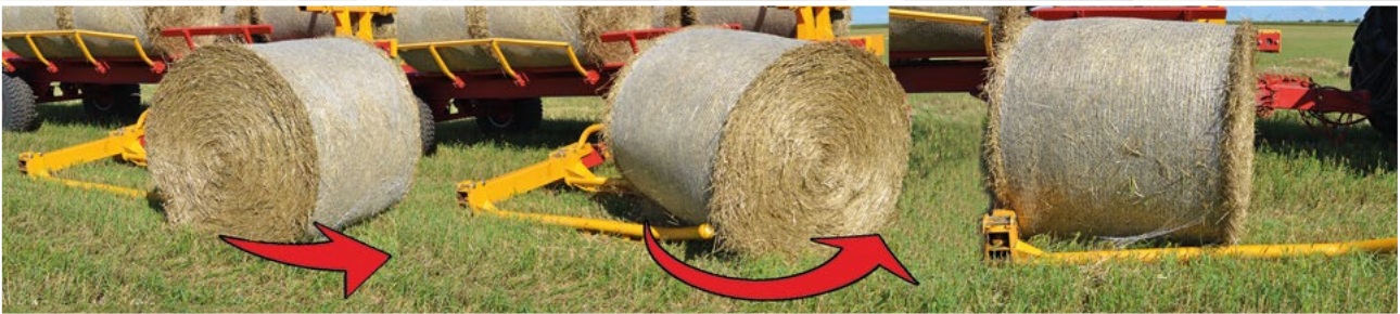
La patte hydraulique universelle en déplacement déplie le rouleau et charge sur la plateforme
