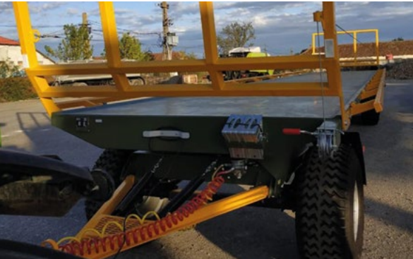
Élargissement de la plate-forme à 3 m
