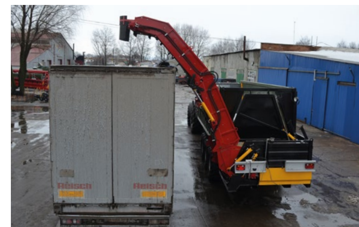
Rechargeuse de betteraves jusqu'à une hauteur de 4,5 m.
