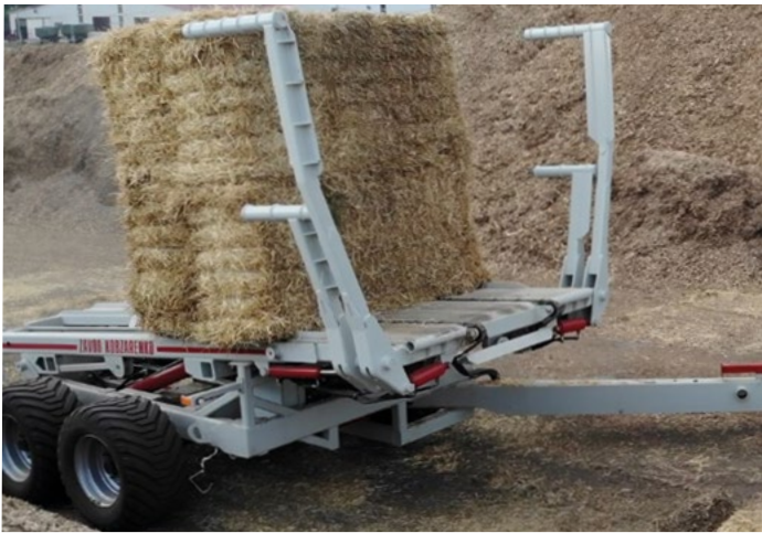
Système de contrôle hydraulique
