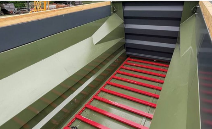
Convoyeur à tablier de 1,3 m de large.
