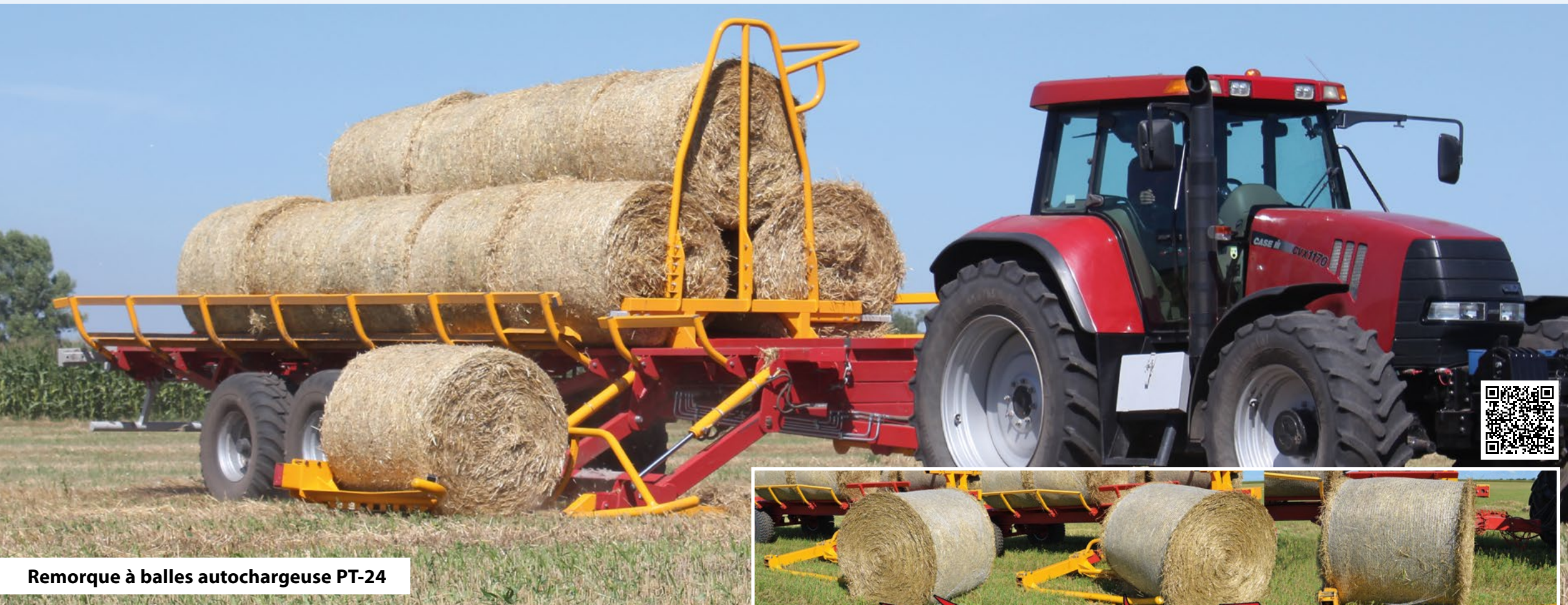
La patte hydraulique universelle en déplacement déplie le rouleau et charge sur la plateforme
