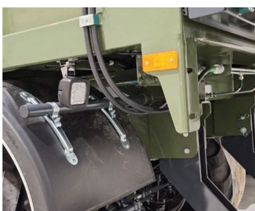
Feux LED latéraux et arrière pour éclairer la piste technologique sur le terrain
