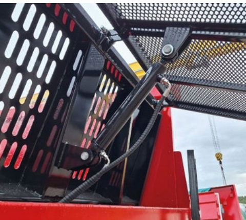
Filet à ouverture hydraulique sur paroi coulissante
