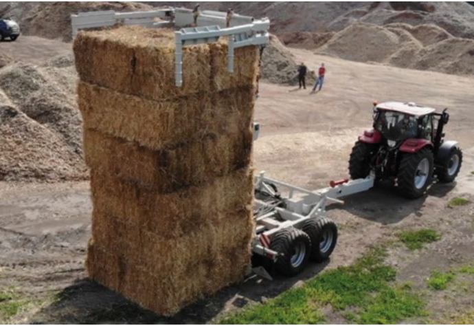
Balles déchargées dans une botte de foin sans utiliser d'équipement supplémentaire
