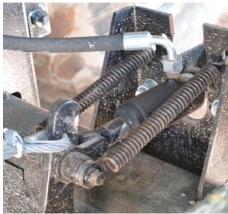
Système de freinage hydraulique
