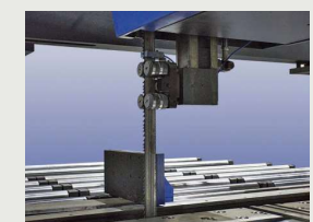
Guias móveis resistentes em 'carbide' com travamento hidráulico.
