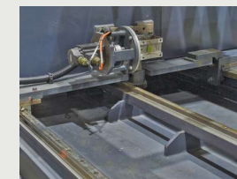
Alimentação da serra com unidade Servo Motor e cremalheira e pinhão através da mesa de 3 metros.
