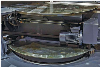
Base com movimento giratório grande e preciso, calculado para suportar e girar carga pesada, permitindo o posicionamento em esquadro de toda a máquina.
