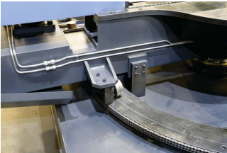
Suporte de rolamentos para giro da estrutura da serra.
