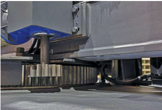
Rotação motorizada do braço de corte no grau desejado com ajuda de motor redutor, codificador rotativo e PLC de última geração através do painel IHM 'touch screen'.
