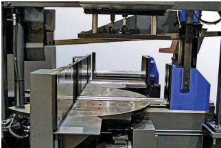
Fixação horizontal do material em ambos os lados da lâmina onde o material permanece completamente preso até a finalização do corte.
