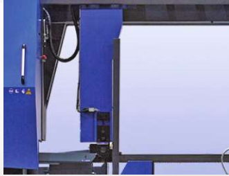
Guia de lâmina móvel para serviço pesado tipo «cauda de pomba», automaticamente ajustável, com recurso de travamento hidráulico.
