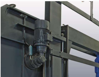
Transmissão de potência de alta eficiência para a serra através da CAIXA DE ENGRENAGENS PLANETÁRIA
