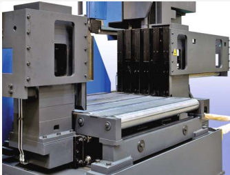
Transporte hidráulico com indexação automática e tornos muito mais largos e pesados para puxar cargas pesadas e sincronizado com o ciclo
