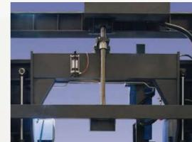
Movimentação do braço de corte com fuso de esfera e servo motor.
