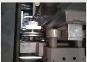
Codificador rotativo para visualização digital da alimentação hidráulica.
