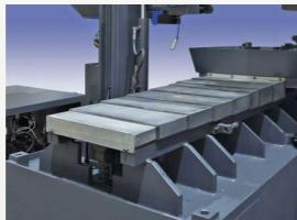
Mesa de trabalho automática com fuso de esferas e servo motor para precisão.
