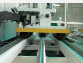
Movimentação da mesa com fuso de esferas e servo motor.
