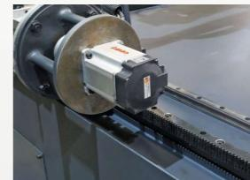
Movimentação do cabeçote de corte com sistema de servo motor Hi-End e alimentação com pinhão e cremalheira.
