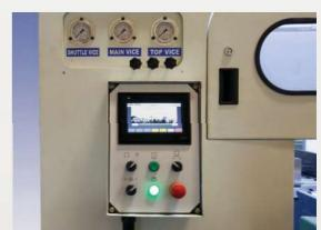
Alimentação do material para corte com uso de servo motor altamente preciso e controlado com tela 'touch screen' de 7,7 pol.
