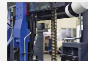
Servo motor e fuso de esferas.
