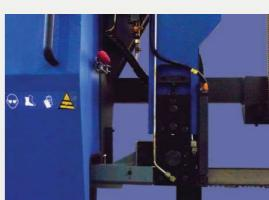
Guias de lâmina móvel e autoajustável tipo 'cauda de andorinha' para serviços pesados, juntamente com o torno móvel.
