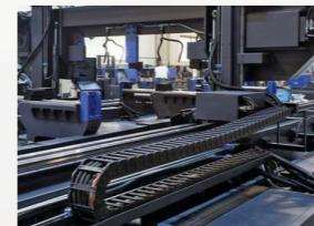
Curso de cabeçote de corte de 12 metros de comprimento com sistema de servo motor Hi-End e alimentação com pinhão e cremalheira.
