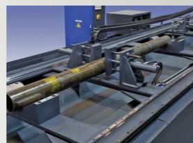
Múltiplas morsas de fixação hidráulicas fixas com apoio em bloco em V.
