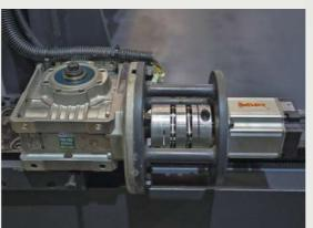
Movimentação de cabeçotes através de Servo motor acoplado à caixa de engrenagens.
