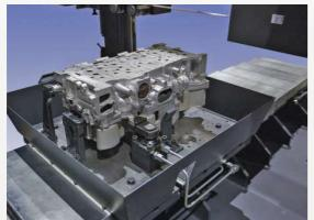
Dispositivo de fixação multiponto operado hidráulicamente especialmente projetado
