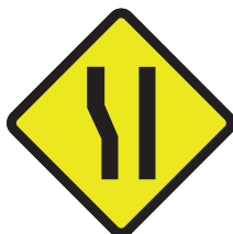
Peringatan Pelebaran Badan Jalan di Bagian Kiri
