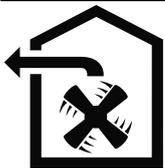
L'air ne doit pas être acheminé dans une cheminée servant à l'évacuation des gaz d'appareils qui sont utilisés pour la combustion de gaz ou d'autres combustibles (cela ne s'applique pas aux appareils de recyclage).
