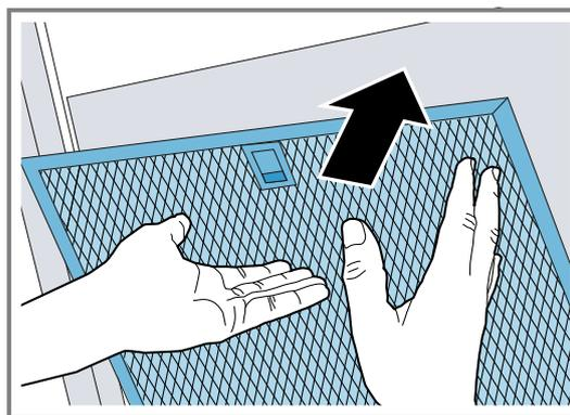
4. Si le filtre à graisse a été mal inséré, poussez avec précaution le loquet vers l'avant, retirez le filtre à graisse et insérez-le correctement.
