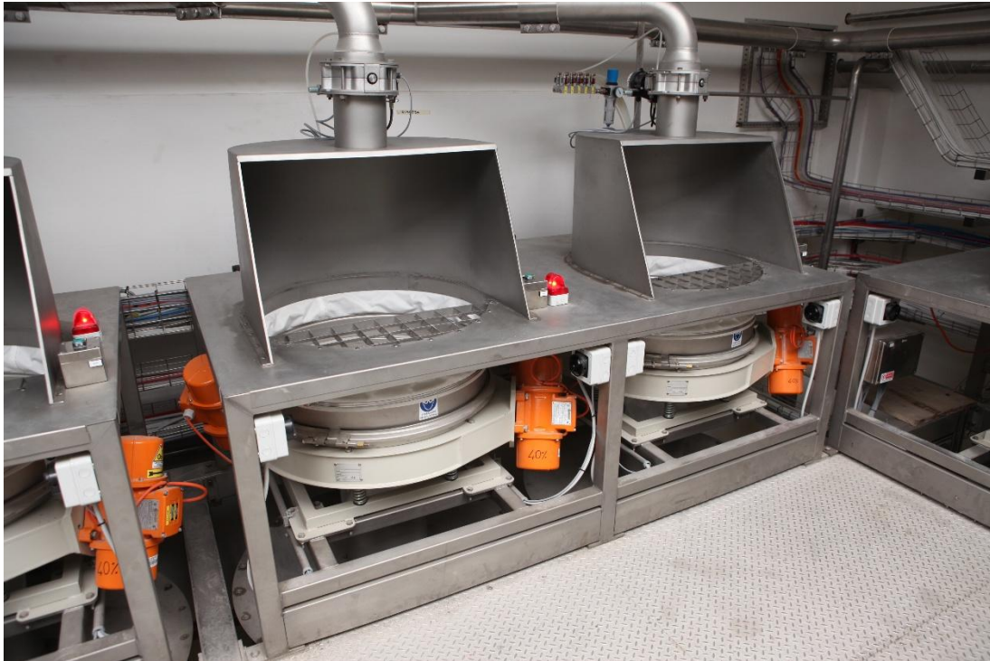
Estaciones de vaciado de sacos
