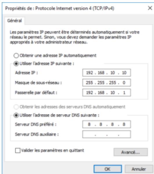
Cochez « **Utiliser l'adresse IP suivante** » et assignez une adresse IP et un masque de sous-réseau. Ici j'ai choisi d'utiliser l'adresse de réseau *192.168.10.0/24*.
