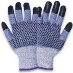
Resistente al corte nivel 5. Supraneema y fibra de vidrio cal 13 con recubrimiento de nitrilo laminado color negro en las puntas de los dedos y puntos en palma y dorso. Ambidiestro.
