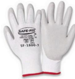
Resistente al corte Nivel 3. Tuffalene® UHMWPE cal. 13 con recubrimiento de poliuretano en palma y dedos. Sin costuras.
