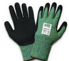
Guante resistente al corte A5. Tuffalene® UHMWPE de alta visibilidad cal. 13. Recubrimiento en palma de doble inmersión de nitrilo acabado Mach Finish color negro. Cumple con las normas antiestáticas electrostáticas para su uso en un área protegida contra ESD.
