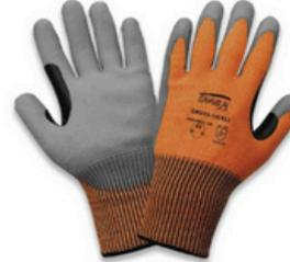
Guante de alta visibilidad resistente al corte. Fibra UHMWPE de marca Tuffalene® calibre 12 sin costuras con la palma recubierta de polietileno gris. Los dedos pulgar, índice y medio son compatibles con pantallas táctiles. Tienen un refuerzo de nitrilo color negro entre los dedos índice y pulgar.
