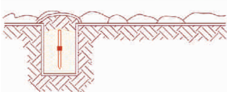
Suelo tratado con Gel mejorador de Resistividad de Suelos (dado el uso de una jabalina profunda o cable).
