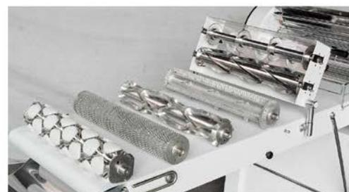
Dispositivo di taglio croissant per modelli ML05T e ML06T da ordinare unitamente alla macchina
