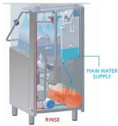
Risciacquo a pressione stabilizzata e temperatura costante dell'acqua del boiler a 85°C. Grazie al boiler atmosferico si evita la miscelazione di acqua di rete nella fase di risciacquo. Il sistema PLUS inoltre, garantisce un maggior controllo ed il corretto dosaggio di brillantante ad ogni ciclo.
