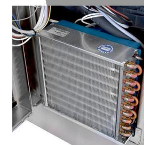
Condensatore protetto da filtri per garantire un funzionamento ottimale nel tempo.
