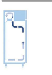
Ottimizzazione dei flussi di circolazione dell'aria all'interno della cella grazie al convogliatore posteriore. Distribuzione ottimale dell'aria in ogni condizione di carico della cella.
