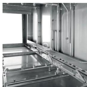
Sistema di avanzamento a doppio traino laterale con frizione incorporata che ne impedisce il deragliamento.
