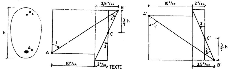
Dans le domaine 1 (ou 1'), le diagramme passe par le point A (ou A') qui correspond pour l'armature la plus excentrée à un accroissement d'allongement de 10 ‰ au-delà du retour à 0 de la déformation du béton adjacent \*.
