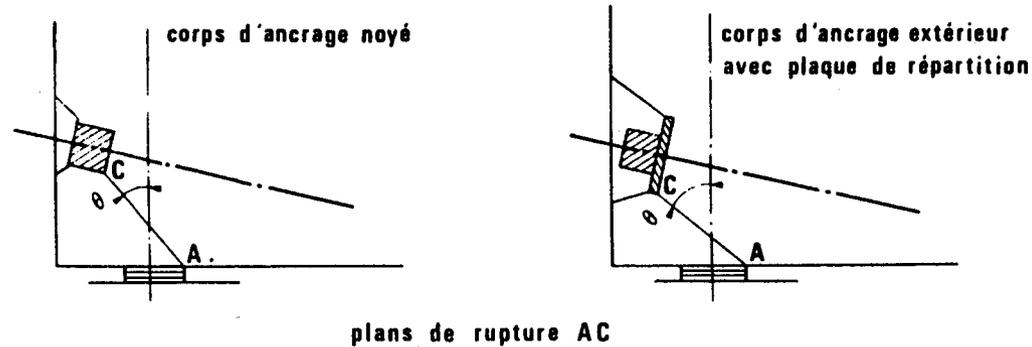
b) Lorsque la bielle d'effort tranchant est équilibrée par des armatures de précontrainte disposées selon plusieurs cours, il y a lieu de considérer successivement toutes les lignes de rupture possibles joignant le nu intérieur de l'appui à l'angle inférieur avant des corps d'ancrage de chacun des cours intéressés.
