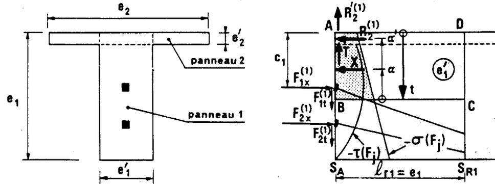
L'équilibre de l'élément ABCD conduit alors aux efforts internes suivants, sur le plan de coupe BC parallèle à la fibre moyenne de la pièce :
