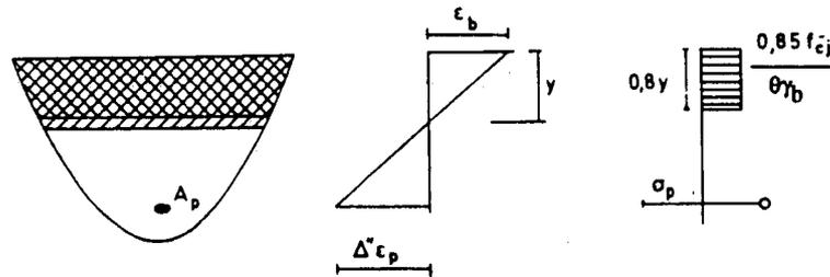
Le diagramme rectangulaire simplifié donne des résultats d'autant plus voisins de ceux du diagramme parabole rectangle que le raccourcissement de la fibre la plus comprimée est proche de 3,5 ‰. Cependant, on peut continuer à l'utiliser quand cette condition n'est pas satisfaite.
