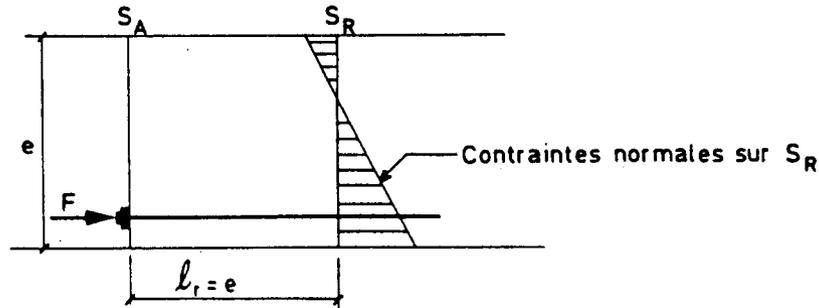
Toutefois, par commodité, on peut se contenter de procéder à deux justifications bidimensionnelles, en étudiant successivement l'étalement des forces de précontrainte dans deux plans perpendiculaires contenant chacun un des axes principaux d'inertie de la section\*.
