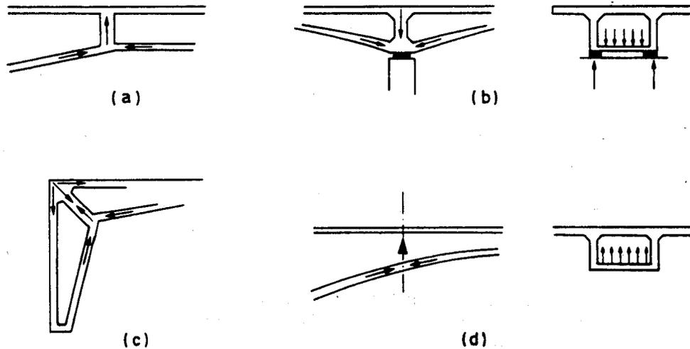
Certains éléments d'une pièce peuvent être soumis à des poussées au vide provenant de la déviation angulaire ou de la courbure :
