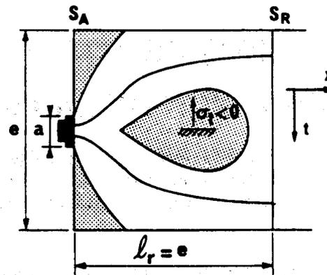
L'équilibre de la pièce exige donc la mise en place d'un frettage de surface et d'un frettage d'éclatement.
