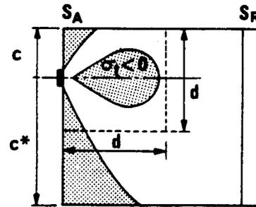
On peut appréhender ces deux effets en admettant que la force  $F$  subit une première régularisation à l'intérieur du prisme symétrique, de dimensions  $d \times d$  dans le plan  $\Delta$  avec  $d = 2 \times \inf(c, c^*)$  et en étudiant par ailleurs l'équilibre général de la zone de régularisation de dimensions  $e \times e$  dans ce même plan.
