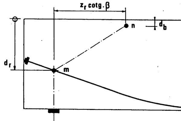
Alors, les armatures transversales susceptibles d'équilibrer  $V_{red, u}$  à l'appui doivent être réparties sur la longueur  $z_r \cotg \beta < z \cotg \beta$ .
