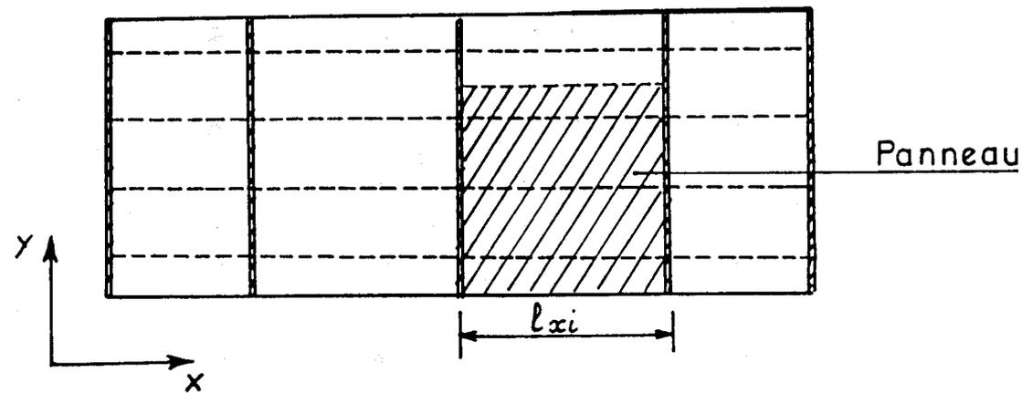
De façon conventionnelle, sur une travée de portée  $l_{xi}$ , on appelle panneau un rectangle de dimensions  $l_{xi} \times l_{xi}$  et de position arbitraire dans la direction Y.
