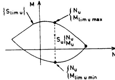
Ainsi, sur la figure (flexion composée non déviée) s'est-on fixé  $N = N_u$ . La justification consiste à s'assurer que :
