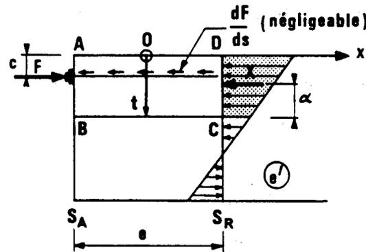
L'équilibre de l'élément ABCD conduit aux efforts suivants, sur le plan de coupure BC, parallèle à l'axe longitudinal de la pièce, et défini par son ordonnée  $t$ .
