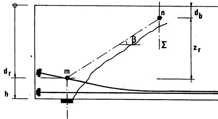
Si l'on admet que les étriers cousant efficacement la fissure sont ceux qui rencontrent la droite mn et que ces armatures sont plastifiées à l'état limite ultime, l'équilibre du bloc d'about exige que le béton, au droit de  $\Sigma$ , transmette un effort vertical :
