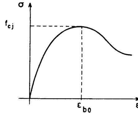
Lorsqu'on applique au béton des cycles de chargement-déchargement au-delà du pic de contrainte, on retrouve la branche descendante de la loi de déformation comme enveloppe des cycles.
