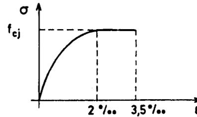
Lorsqu'il est nécessaire d'évaluer les déformations avec une plus grande précision, et notamment dans les calculs de stabilité de forme, le modèle parabole rectangle n'est généralement pas suffisant.
