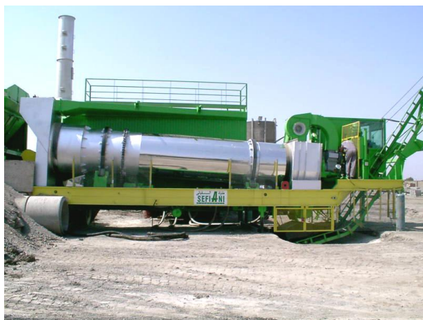
Vue du tambour sécheur
