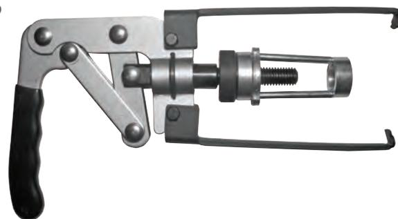
Palanca Prensa Resorte de Válvulas
