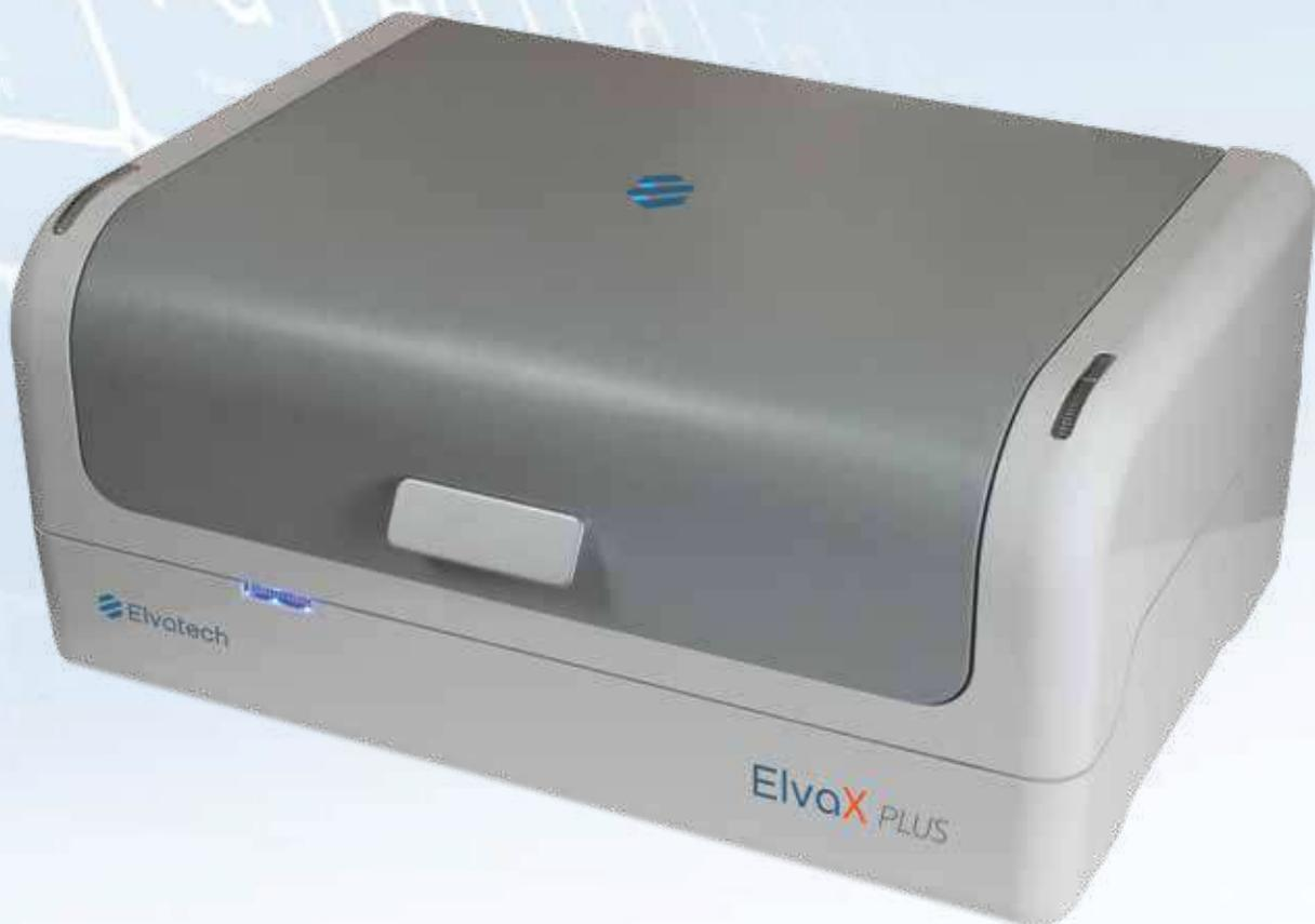
El Espectrómetro ElvaX Plus es un analizador de Fluorescencia de Rayos X por Energía Dispersiva (EDXRF) de sobremesa, con un rango elemental extendido de Na (Z=11) a U (Z=92). El Sistema de Purga de Helio y el cambiador de filtros primario automático, combinado con el detector de área grande tipo SDD se usan para permitir registro efectivo del espectro de elementos ligeros.
