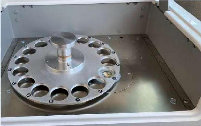
El automuestreador automático (Opcional) de 16 posiciones permite incremento en la producción de su laboratorio, logrando procesar hasta 100 muestras por día.
