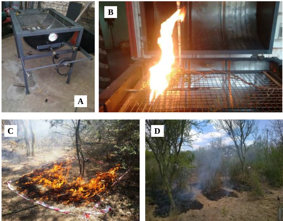
Figura 10. Evaluación de inflamabilidad. A. Vista de epirradiator, según diseño de Jaureguiberry et al. (2011) B. Ensayo de inflamabilidad en laboratorio C. Quema experimental a campo D. Evaluación posquema experimental.
