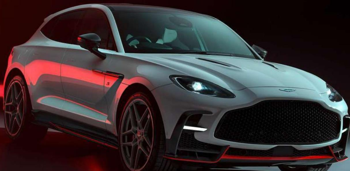
Outre le gain de dynamisme, l'autre objectif principal du DBX S était de réduire la masse, même si ces mesures d'allègement sont toutes optionnelles. Aston Martin proposera un toit en fibre de carbone, la plus grande pièce en fibre de carbone jamais installée sur une Aston Martin. Ce toit nécessite le retrait des rails de toit et représente un gain de poids de 18 kg.
