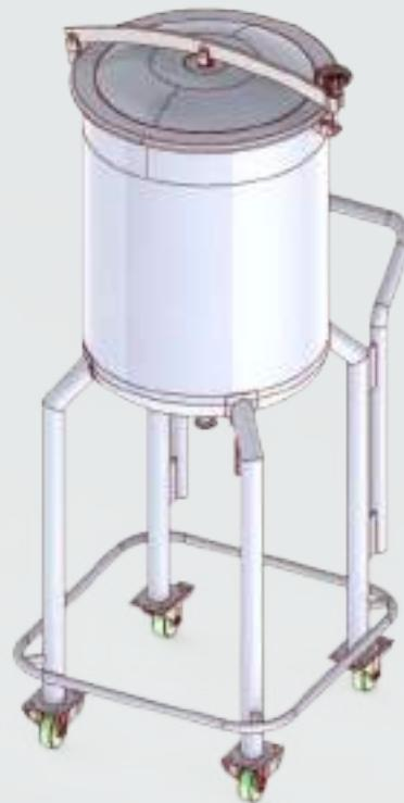
Banyak kebutuhan industri menggunakan peralatan yang mudah dipindahkan. Biasanya untuk transfer product di berbagai lokasi. Industri berbasis liquid banyak membutuhkan movable tank untuk transportasi raw material ataupun finish goods. Kemudian portable tank bisa digunakan untuk CIP tanki atau paping dan transfer raw material dari drum.
