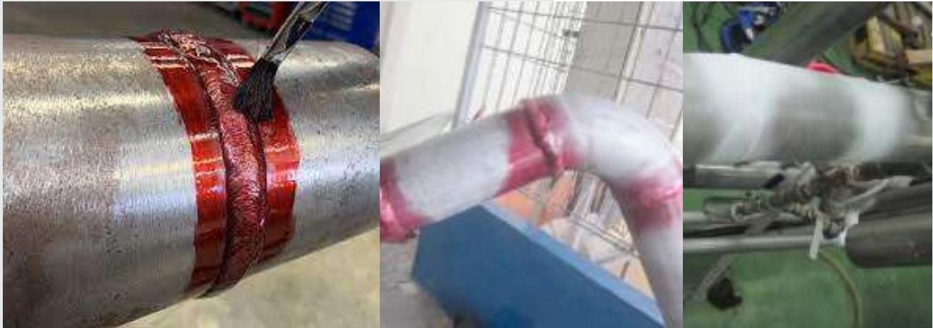
Setiap penggerjaan project selalu menjalani tahapan dari mulai desain drawing, pembelian material, fabrikasi, dan instalasi di customer site. Setiap tahapan selalu ada proses pengecekan. Salah satu contoh pengecekan oleh quality kami adalah penetrant test untuk memastikan hasil weldingan tidak ada kebocoran.
