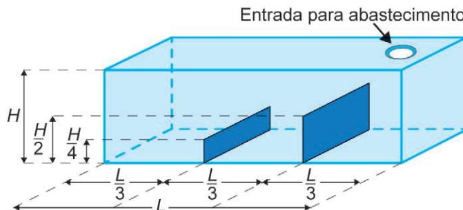
Esses anteparos, de espessuras desprezíveis, estão instalados de maneira a dividir a base do tanque em três retângulos congruentes, tendo suas alturas iguais à metade e a um quarto da altura do tanque. O tanque é abastecido por uma entrada situada no teto, através de um duto que despeja água a uma vazão constante, sendo necessárias 12 horas para finalizar o seu enchimento.
