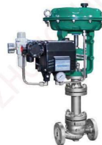
气动波纹管调节阀 Pneumatic Bellows Control Valve 公称口径: DN15-300 公称压力: PN10-100 制造标准: GB, JB, HG, ANSI, JIS
