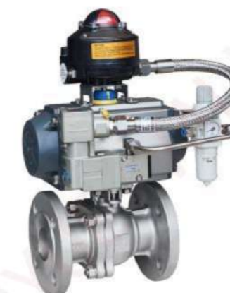
气动法兰球阀 Pneumatic Flange Ball Valve 公称口径: DN15-250 公称压力: PN10-100 制造标准: GB, JB, HG, ANSI, JIS, DIN
