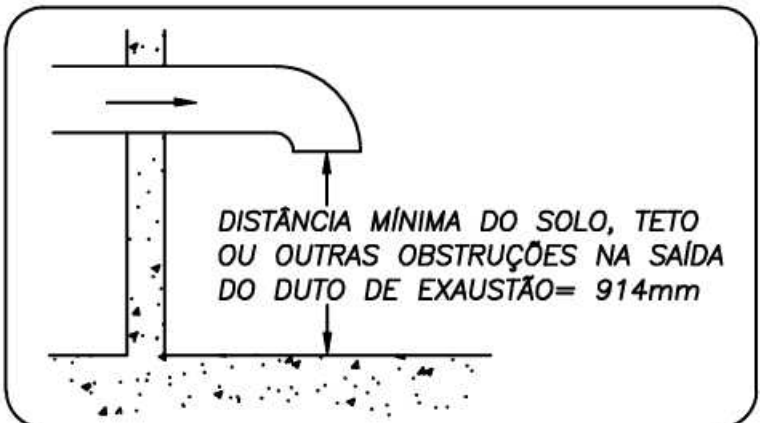
SAÍDA DO DUTO DE EXAUSTÃO
