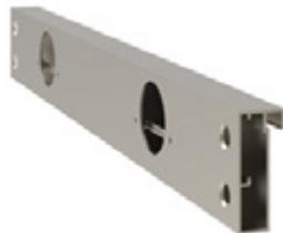
Perfil base de 50mm cortado a 90° con mecanizado para bisagras para unión con perfil 9491 Union Mix.
